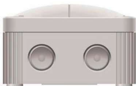
Специальная выпуклая крышка, дает до 10% дополнительного свободного места в коробке. Специальные ребристые углы для большей прочности
